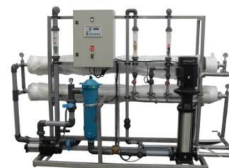
La filtration par osmose inverse est généralement considérée comme la plus efficace des systèmes de traitement des eaux disponibles, l'osmose inverse est un procédé de séparation en phase liquide par perméation à travers des membranes semi-sélectives sous l'effet d'un gradient de pression.
